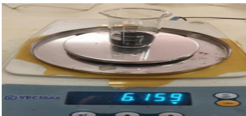
Figura 11 – Medição da massa do carvão
